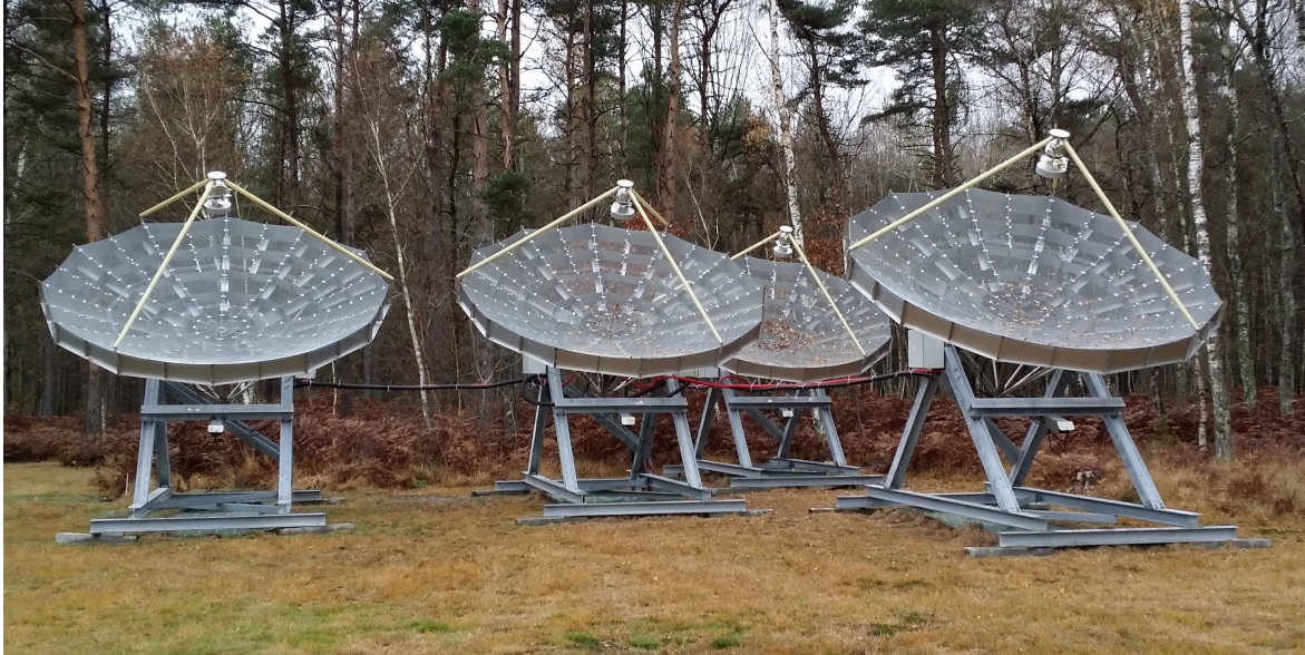
FIGURE 2 – PAON4 : interféromètre de test comprenant 4 réflecteurs de 5 mètres de diamètre
